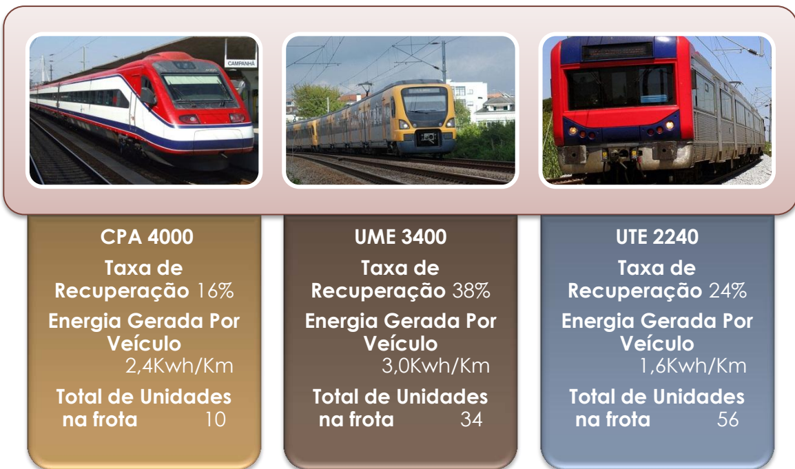
Ilustração 19 – Material Circulante com frenagem regenerativa e respectiva eficiência energética.
