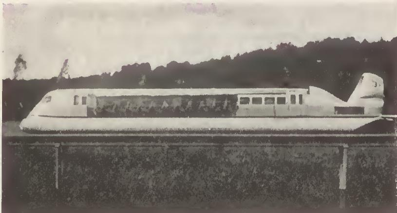
O veículo experimental de 80 lugares cujos ensaios tiveram lugar em Junho último. A propulsão é feita por dois turbomotores de 1300 CV
